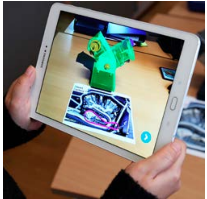
Augmented Reality Applikation, in der ein reales Objekt von einem digitalen 3D Modell überlagert wird.
