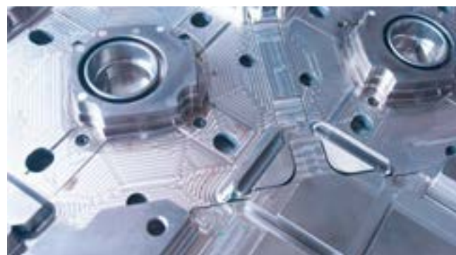
Abb. 3.1: Werkzeug für den Zweikomponenten-Kunststoffspritzguss mit Innenkühlung.
