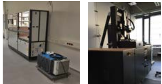
Abb. 4: Plasmasphäroidisieranlage (links) und Forschungsanlage für das selektive Laserschmelzen (rechts) der Universität Innsbruck, Institut für Mechatronik / Werkstoffwissenschaften
