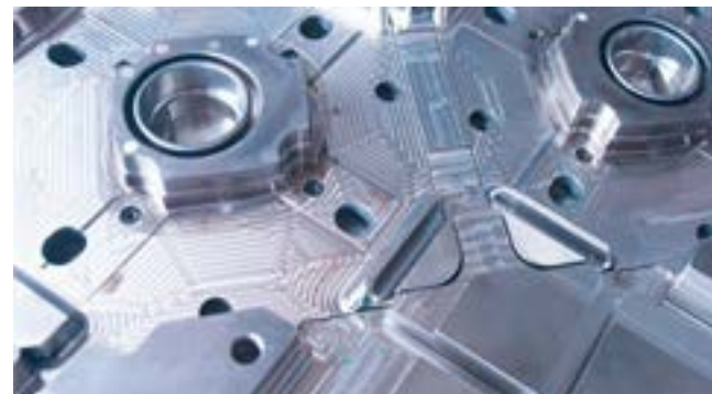
Fig. 3.1: Utensile per la pressofusione in plastica a due componenti con raffreddamento interno.
